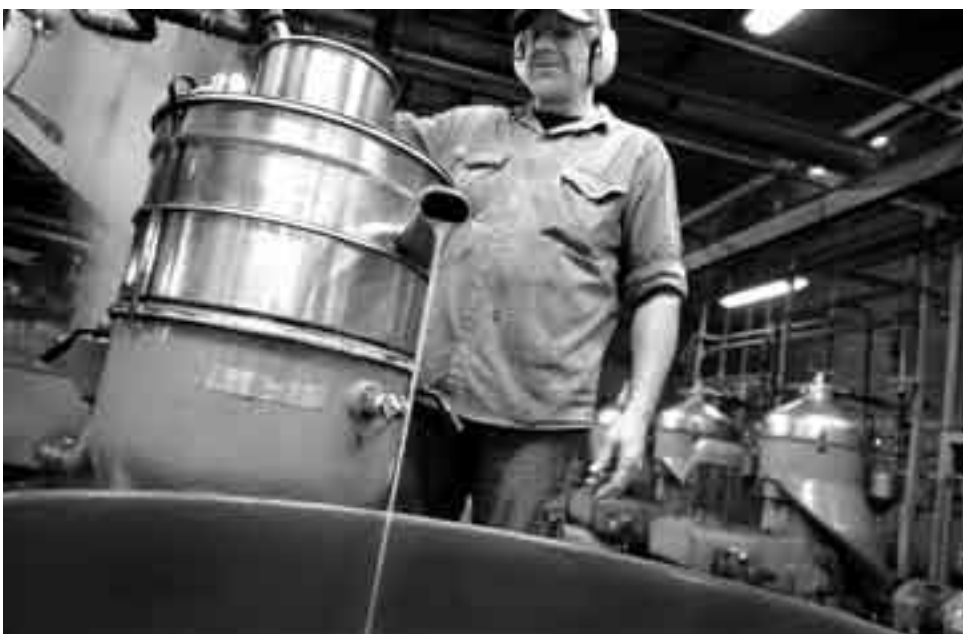
Sector de centrifugado de las aguas residuales del lavado, donde se obtiene la grasa de lana en Tops Fray Marcos.
